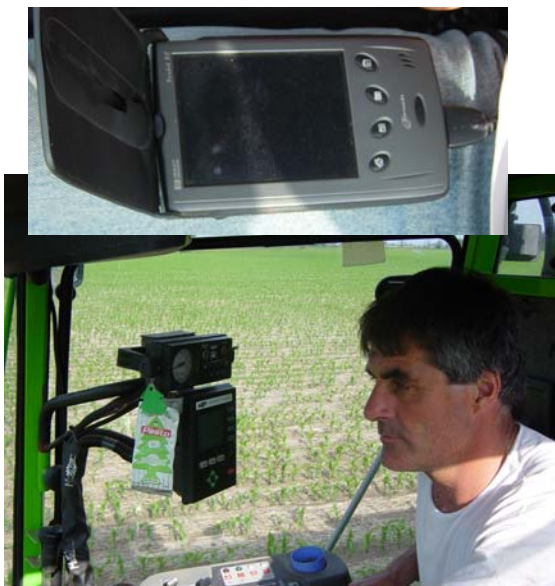
Aplicación variable de UAN chorreado mediante Land Manager, palm top con programa específico, y GPS.
