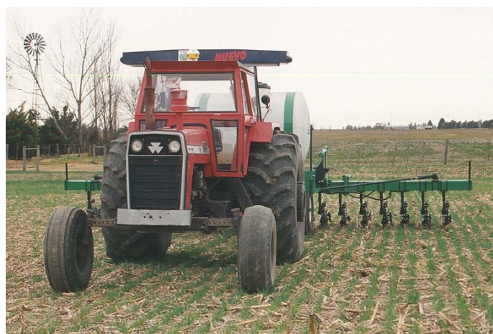
Aplicación variable de UAN incorporado, en trigo, mediante la utilización del sensor en tiempo real de Índice Verde y Biomasa, Nsensor de Hydro, computadora Land Manager, y GPS para grabar las lecturas y el mapa de aplicación.
