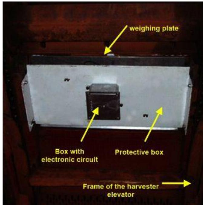
**Figura 2:** posición de la balanza sobre el elevador de la cosechadora; vista desde abajo (*weighing plate*: placa de pesaje; *box with electronic circuit*: caja que contiene el circuito electrónico; *protective box*: caja protectora; *frame of the harvester elevator*: chasis del elevador).
