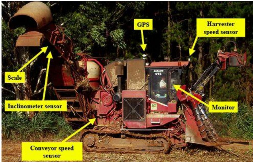
**Figura 1:** componentes de la cosechadora de caña de azúcar y ubicación del sensor de rendimiento.
